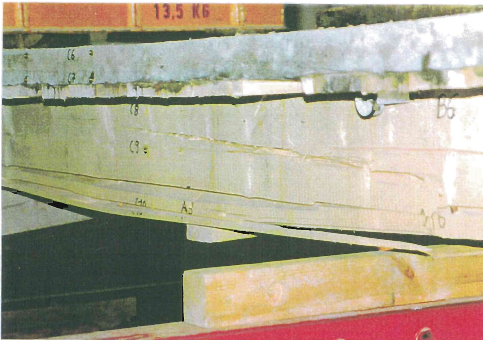
Bild 6 Holz-Beton-Verbund Bruch im Balken bei Biegeprüfung
