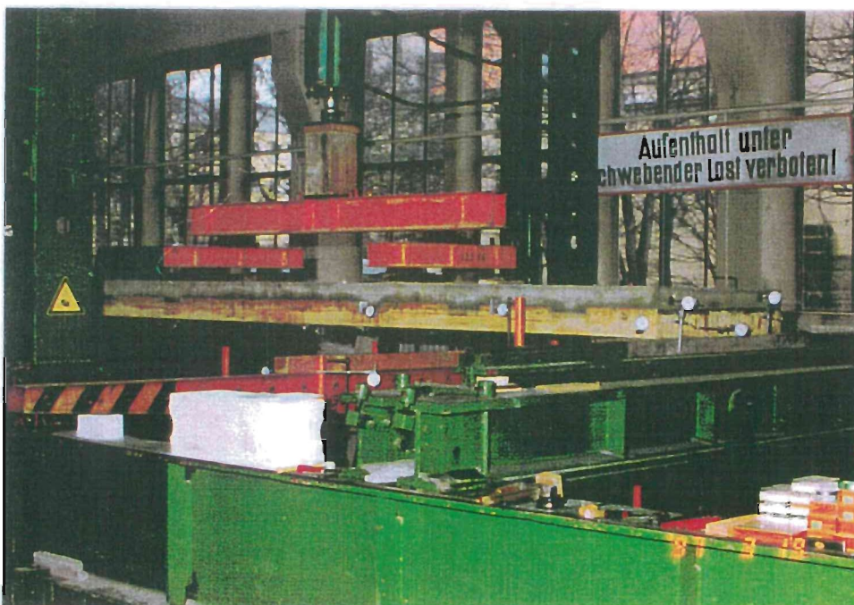
Bild 7 Holz-Beton-Verbund Brettstapelelement mit Kernen (Biegeprüfung)
